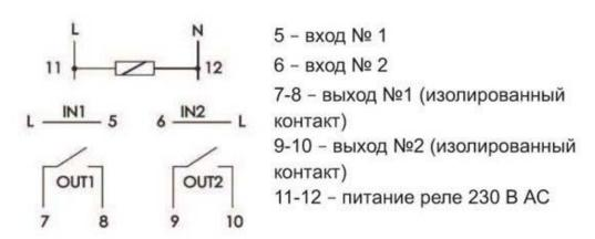
На рисунке представлены схемы подключения данного реле в качестве устройства автоматизации регулируемого проезда.
