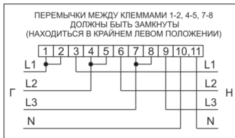
Рисунок Б.2 – Схема включения счетчиков в корпусах W31 и D33 непосредственного включения на измерительных элементах трансформаторах тока
