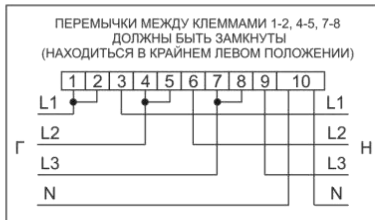
Рисунок Б.7– Схема включения счетчиков в корпусах W32 непосредственного включения на измерительных элементах трансформаторах тока
