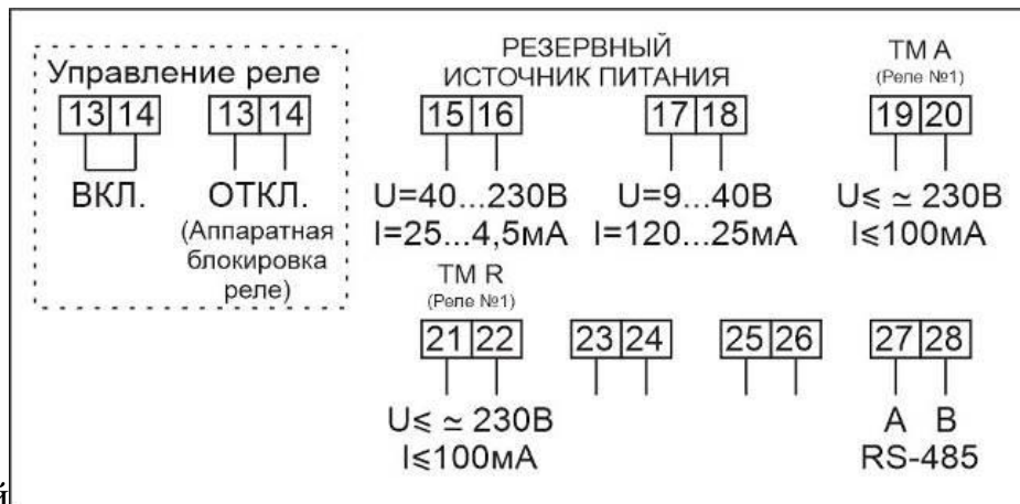
Рисунок Б.32 – Схема включения сигнальных цепей счетчиков в корпусе W32 с интерфейсом RS-485, с двумя дискретными выходами, входом для подключения резервного источника питания, аппаратной блокировкой встроенного реле управления нагрузкой
