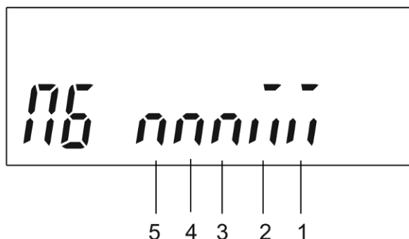
Рисунок 3.8 – Режимы индикации состояния электронных пломб счетчика
