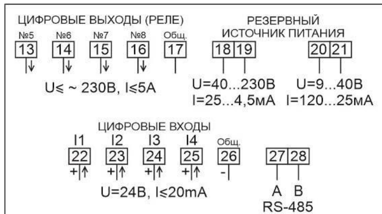
Рисунок Б.30 – Схема включения сигнальных цепей счетчиков в корпусе W32 с интерфейсом RS-485, с четырьмя дискретными выходами и с четырьмя дискретными входами, входом для подключения резервного источника питания
