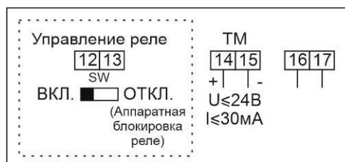
Рисунок Б.19 – Схема включения сигнальных цепей счетчиков в корпусе W31 с одним дискретным выходом, настроенным как телеметрический выход и аппаратной блокировкой встроенного реле управления нагрузкой
