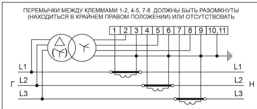
Рисунок Б.4 – Схема включения счетчиков в корпусах W31 и D33 трансформаторного включения через три трансформатора напряжения и три трансформатора тока
